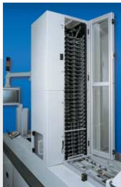
La torre paternóster separada garantiza el excelente brillo de los resultados de impresión.
