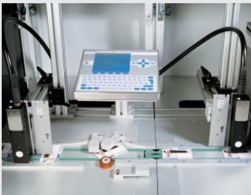
Le module de pivotement tourne les cartes du sens transversal dans le sens longitudinal et permet ainsi de marquer dans les deux directions.
