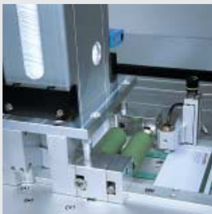
Magasin standard pour 500 cartes au maximum en 0.8 mm d'épaisseur, à déliassage par friction et capteur de contrôle de double carte.
