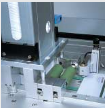
Depósito estándar para hasta 500 tarjetas de 0,8 mm de espesor, con separación por fricción y sensor de control de doble tarjeta.
