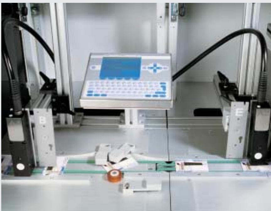
Das Drehmodul dreht die Karten vom Quer- ins Längsformat und ermöglicht so die Kennzeichnung in beide Richtungen.
